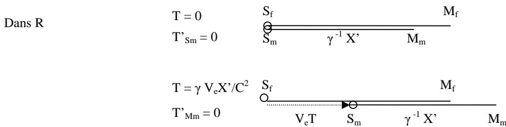
Dans R, pour mesurer une vitesse constante pour la lumière, il faut nécessairement que toutes les horloges indiquent simultanément la même heure. Lorsque l'observateur de R mesure la règle en mouvement, il repère ses deux extrémités au même instant T et mesure la contraction physique subie par la règle.
